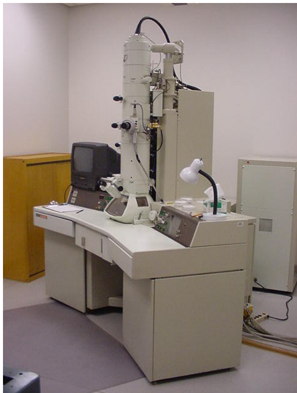
Fig. 4.2. Foto e representação esquemática do microscópio eletrónico de transmissão
