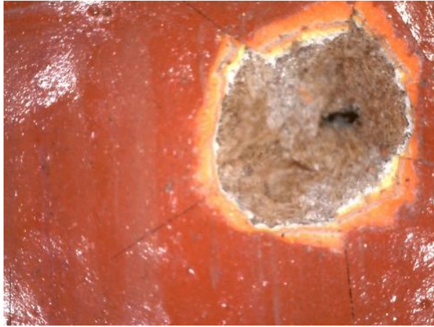
Figura 52: Imagem obtida ao microscópio digital com uma ampliação de 50x - Ponto vermelho com lacuna.
