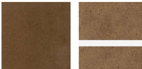
Figura 36: Plutex designado panotex de ambas as superfícies planas para isolamento térmico e acústico (Imagem retirada de Garrido, 2003, p. 850).
