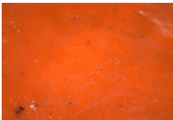
Figura 51: Imagem obtida ao microscópio digital com uma ampliação de 50x – sujidades detetadas no Laranja original.
