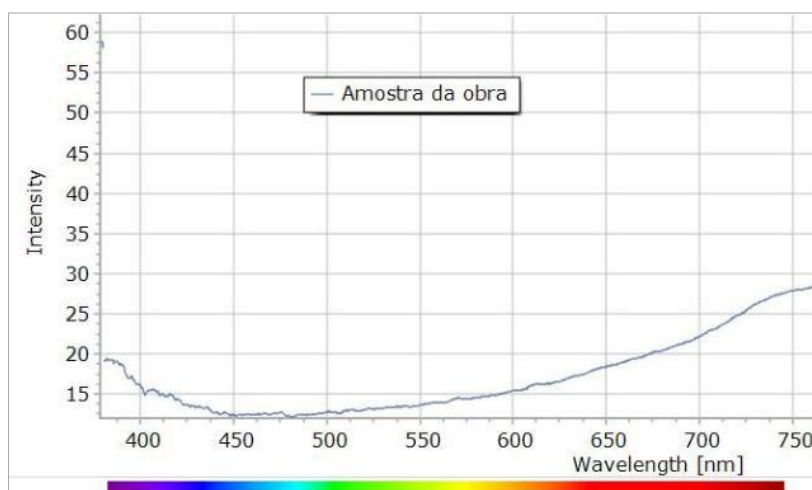
Figura 33 - Espectro de refletância da amostra de carnação da pintura. (Eixo y: Intensidade de refletância, em %. Eixo x: comprimento de onda, em nm).
