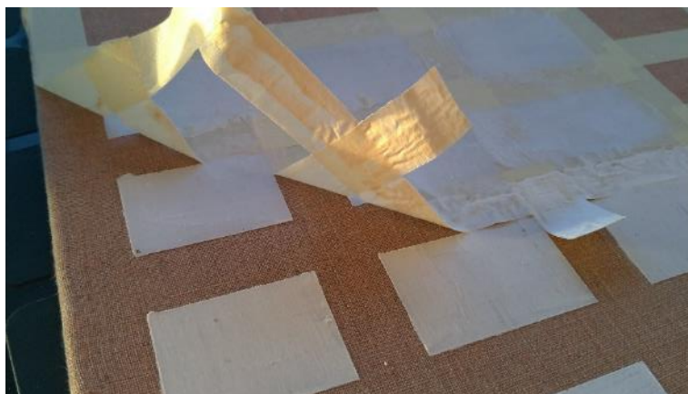
Figura 2 – Remoção das fitas-cola após aplicação das massas.
