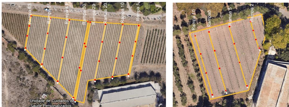
Figura 12: Esquema representativo das medições nas parcelas da vinha (à esquerda) e do olival (à direita). Os pontos encarnados representam as medições de caudais e os pontos brancos representam as medições das pressões
