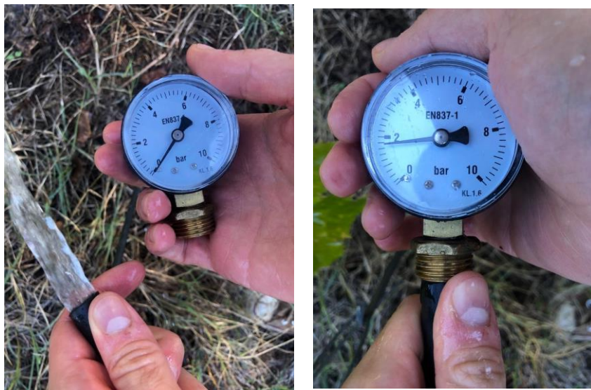
Figura 11: Medição das pressões, utilizando um manómetro
