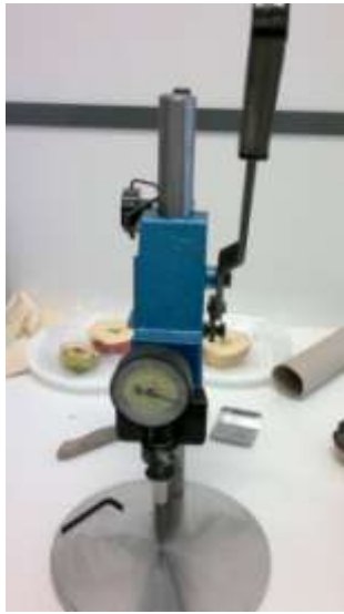
Figura 6: Penetrómetro manual montado num suporte com alavanca
