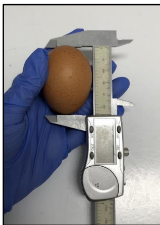
Figura 12- Medição da altura do ovo.
