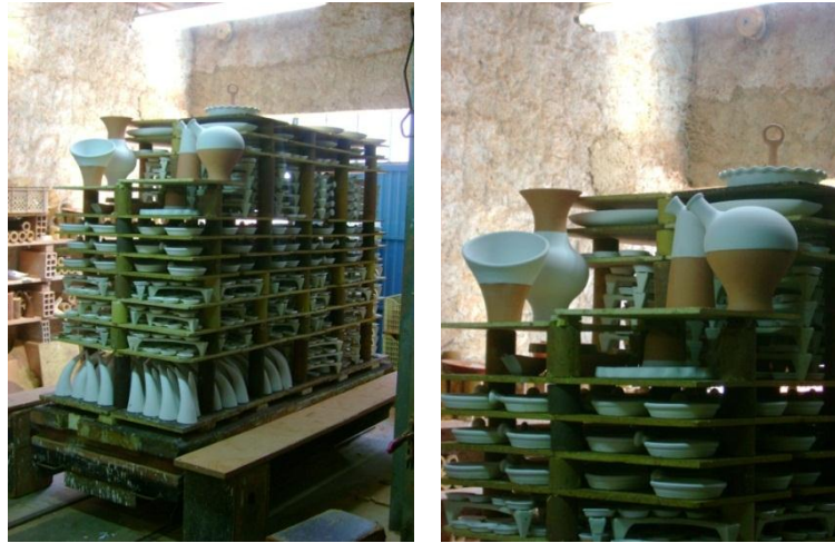
Figura 47. Produtos preparados para a segunda cozedura
