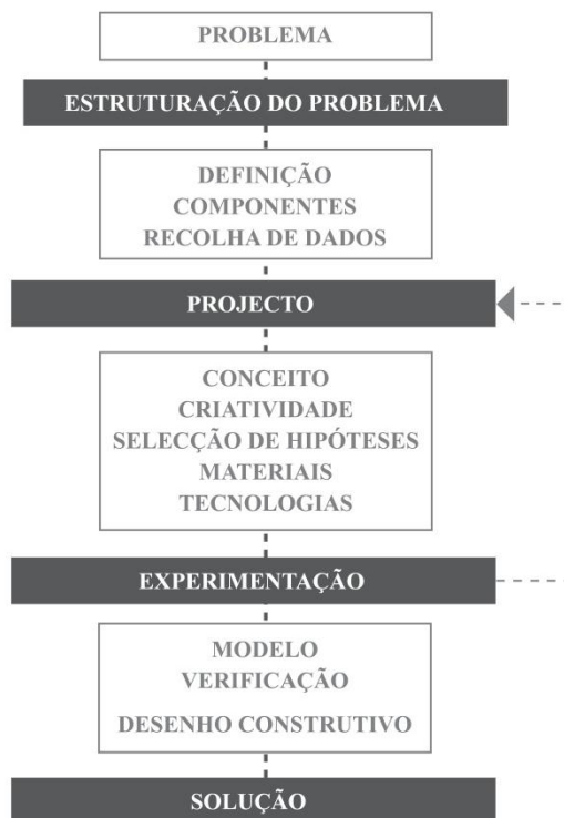
Figura 25. Esquema representativo sintético do processo do Design
