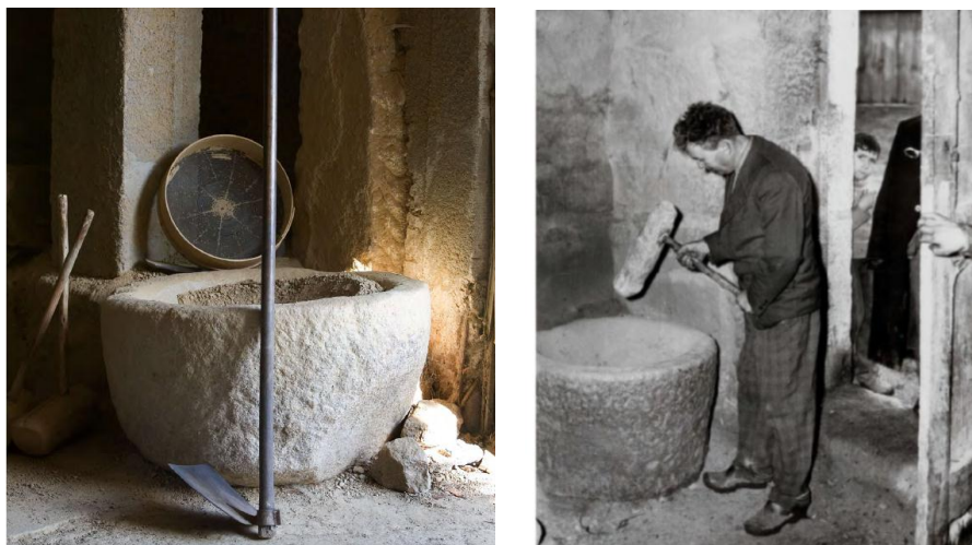
Figura 5. Utensílios usados na extracção - sachola - e na preparação do barro - pio, peneira e picos
