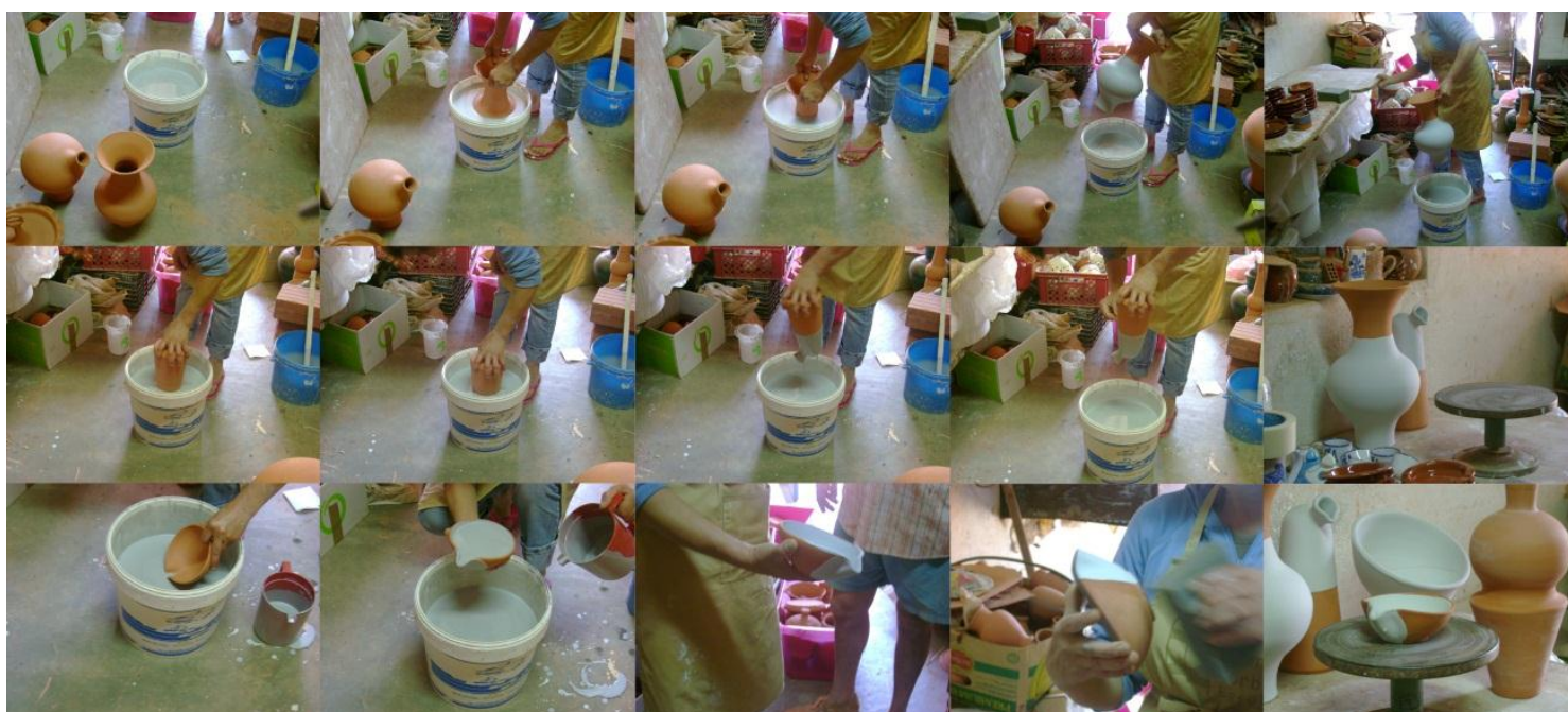
Figura 46. Processo de vidragem de alguns produtos
