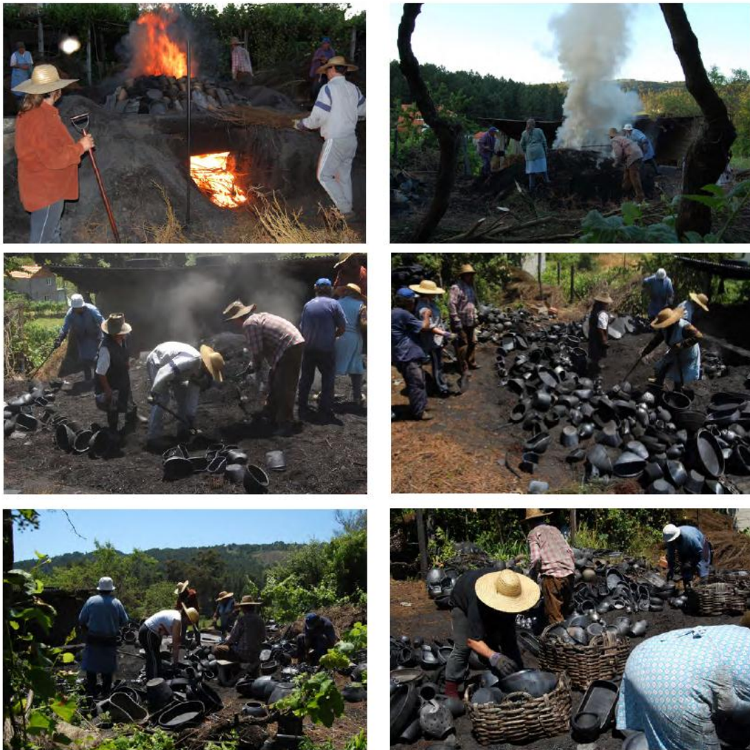
Figura 12. Processo de Cozedura e retirada das peças após cozida
