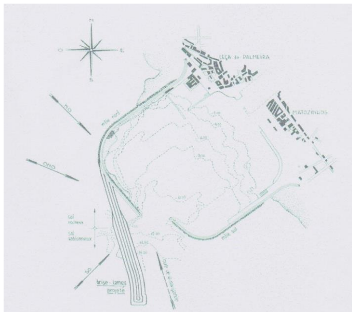
Figura 48. Plano geral do porto de Leixões. Implantação do quebra-mar projetado. Fonte: Stucky e Bonnard, «Contribution à l'Etude...,1937, 232.
