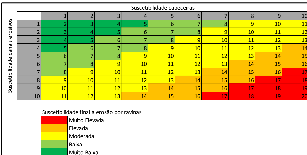
Figura 3.14: Matriz de suscetibilidade final da erosão por ravinamentos resultantes da combinação da combinação da suscetibilidade das cabeceiras e da suscetibilidade dos canais erosivos
