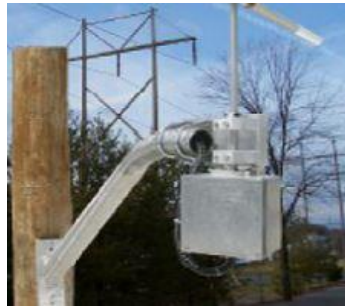
Figura II. 1: ThermalRate Aparelho utilizado para medir a temperatura da linha [Fonte (E, et al. 2015)].
