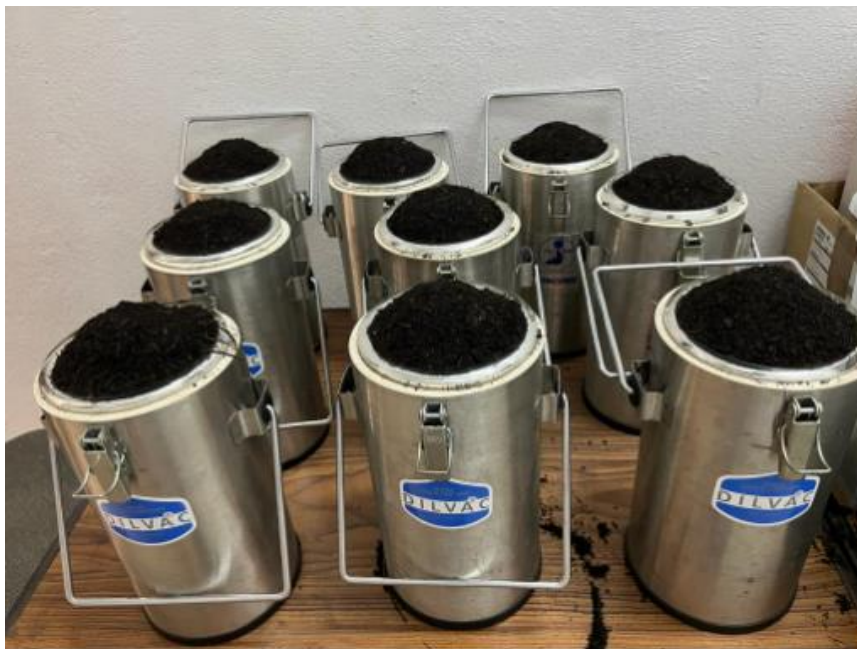
Figura 7 – Teste de Auto Aquecimento com Duração de 1 Mês.
