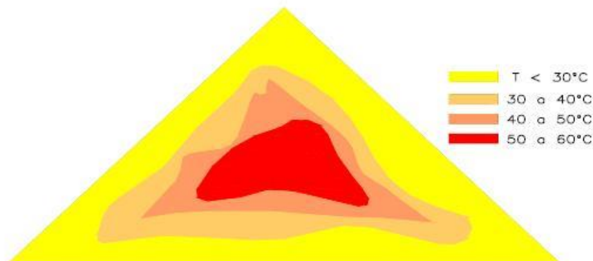
Figura 5 – Perfil Típico de Temperatura numa Pilha Aeróbia. (fonte: Russo, 2004).
