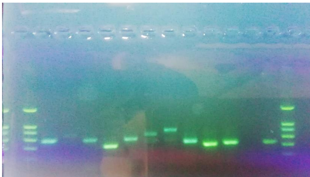
Figura 48 – Bandas obtidas por eletroforese em gel de agarose do ADN amplificado das leveduras isoladas. Nos extremos encontra-se o padrão de peso molecular DNA Ladder I (NZYTech).
