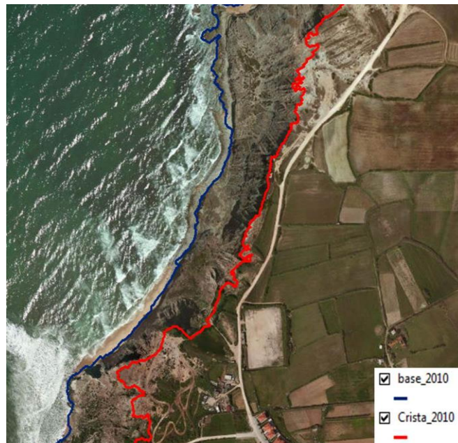
Ilustração 57 - Parte da área de estudo onde se encontram representadas as linhas da crista e base da arriba estereorrestituídas.
