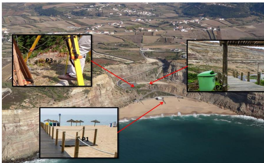
Ilustração 55 - Localização dos pontos estação (P1 e P3) e ponto de orientação (P2), no levantamento com TLS na praia do Porto da Calada.
