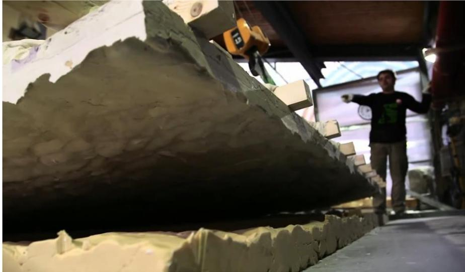
Fig. 58- imagem de vídeo, separação do molde do modelo
