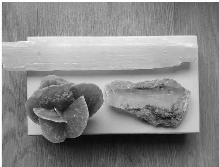
**Figura 1** · Diversas tipologias de minerais de onde deriva o gesso. Fonte: própria
