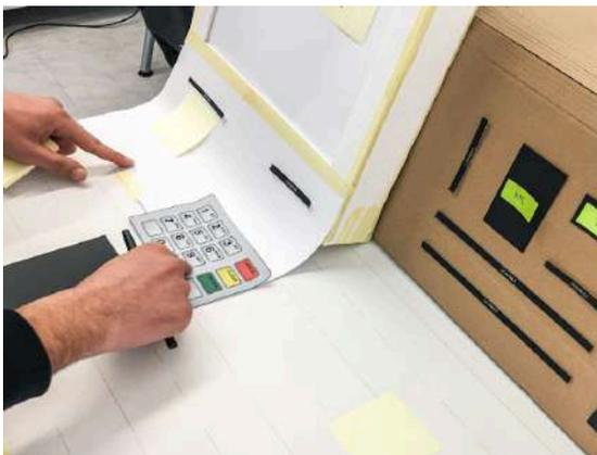
**Fig. 102** - Protótipo em Cartão - Modelo em cartão à escala real de um sistema de ATM self-service para a Newvision, para validar ergonomia, usabilidade e layout de componentes - Fonte: INNGAGE.
