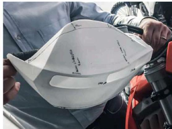
**Fig. 103** - Protótipo SLS - Protótipo de um protetor de mão para motos de *enduro* para a Polisport SA, para testar a funcionalidade e o sistema de fixação ao guiador - Fonte: INNGAGE.
