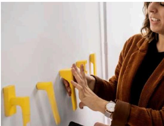
**Fig. 104** - Teste de Usabilidade - Sessão de teste com utilizadores a protótipos de puxadores de janela para validar ergonomia e estética, em colaboração com a empresa Alualpha SA - Fonte: INNGAGE.
