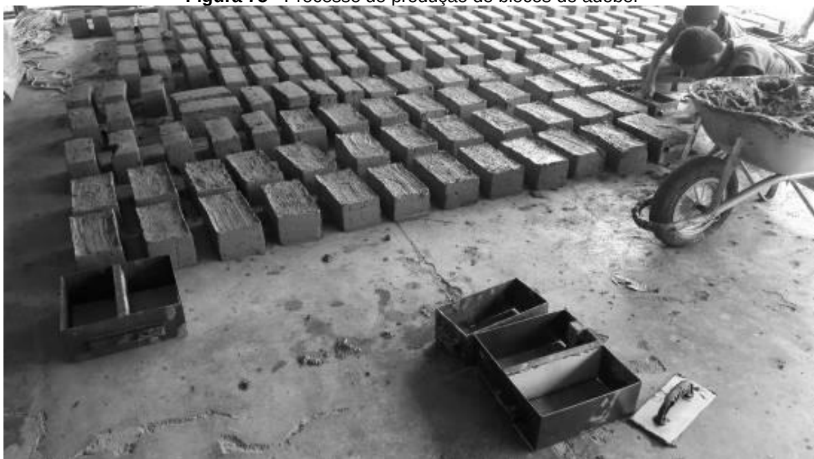
Figura 75 - Processo de produção de blocos de adobe.
