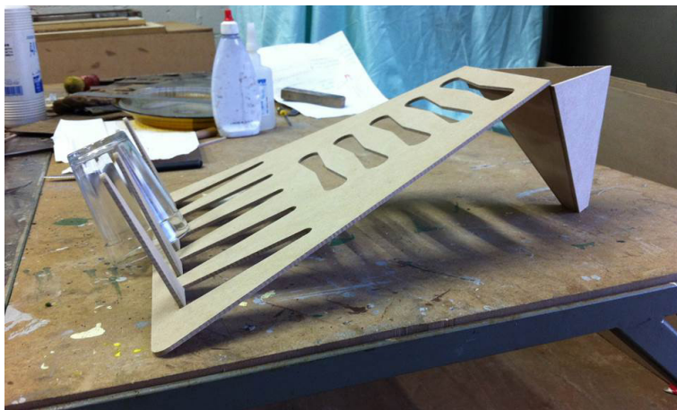
Modelo em MDF sem acabamento superficial para avaliar a funcionalidade do design do escorredor de louças
