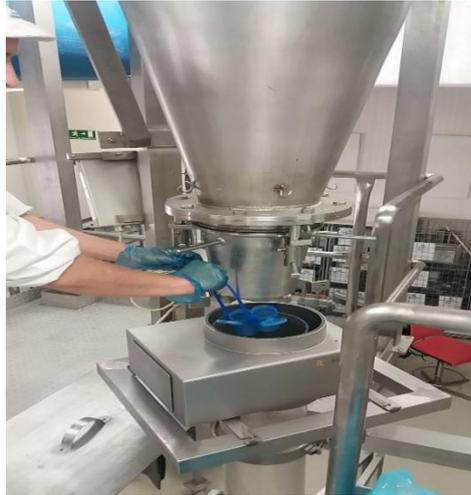
Figura 16 - Local de Recolha de Amostra de Água de Lavagem e/ou Desinfecção (Final da Tremonha Superior)
