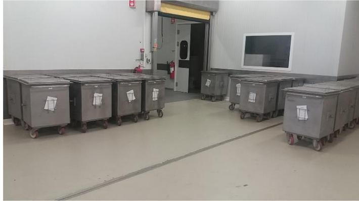
Figura 7 - Carrinhos Usados para a Pesagem e Transporte dos Ingredientes Minoritários
