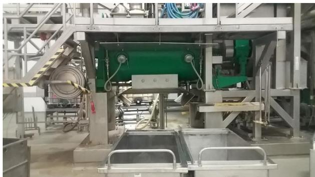
Figura 8 - Saída do Misturador e as Respetivas Banheiras de Receção do Preparado que será Posteriormente colocado nas Tremonhas Superiores
