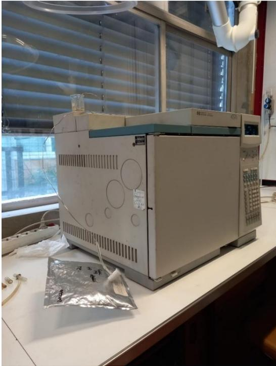
Figura A.5- Fotografia do processo da análise química do produto gasoso pelo aparelho de cromatografia, Agilent / HP 6890.
