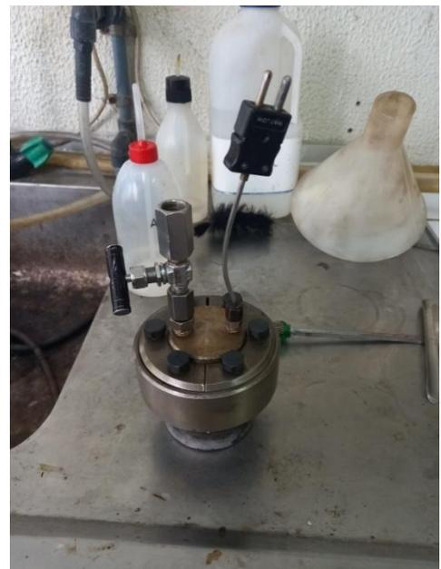
Figura A.8- Fotografia da autoclave na qual foram realizados os ensaios experimentais, construído em Hastelloy C-276 pela Parr Instruments.
