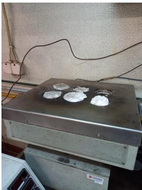
Figura A.3- Fotografia do forno utilizado no aquecimento da autoclave construído por Termolab – Fornos Elétricos, Lda.
