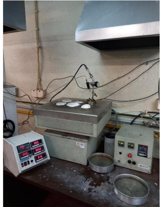
Figura A.6- Fotografia da realização do ensaio experimental, representado o processo de aquecimento da autoclave pelo forno elétrico.
