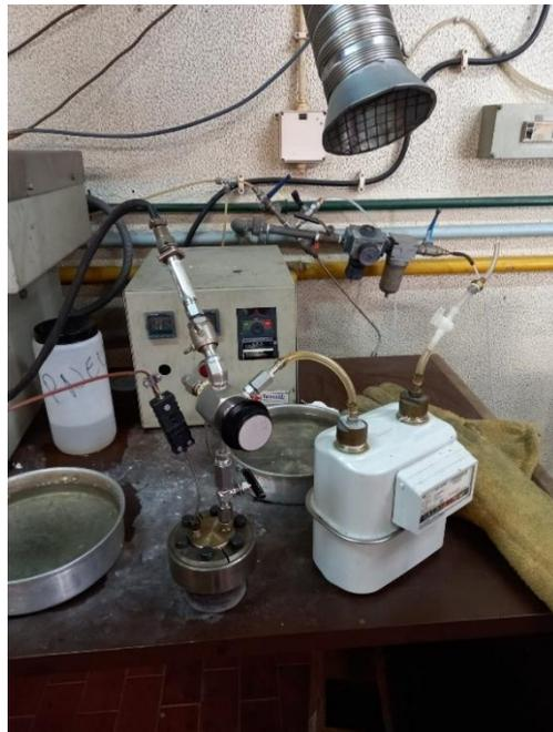
Figura A.4- Fotografia da extração do produto gasoso para o medidor de volume, de modo a quantificar o seu volume.
