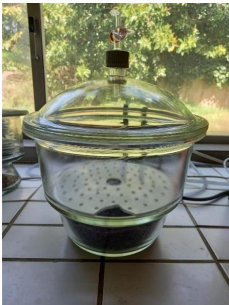
Figura A.7- Fotografia do exsicador utilizado para a secagem no processo de separação de produto líquido do sólido.
