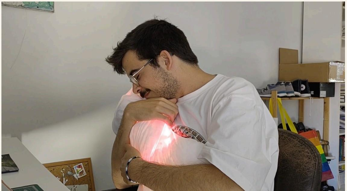
**Figura 17** - Dispositivo transmite batimentos e simula calor humano (Fonte: Autor)
