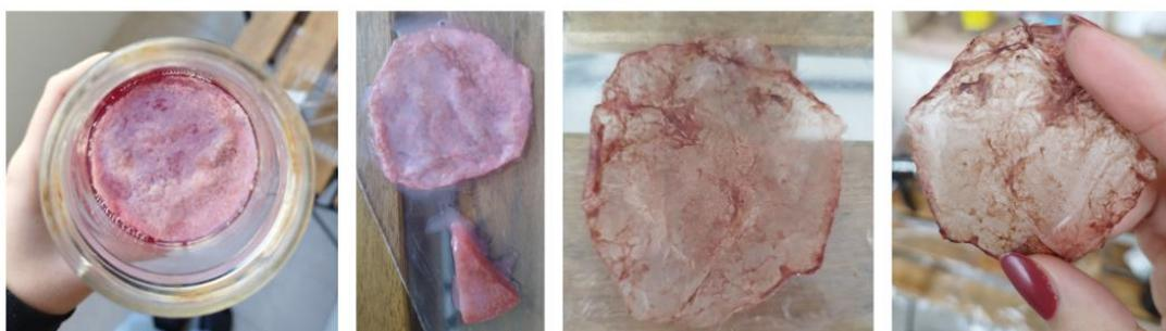
Figura 39 - Secagem amostra beterraba, grupo de teste A: retirada e secagem do biofilme irregular.
