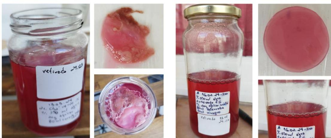
Figura 45 - Testes de beterrada, grupo B: resultado do biofilme do novo teste e resultado do biofilme do teste anterior (A).
