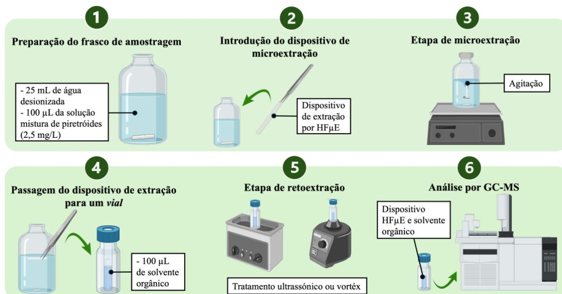
Figura 2.1. Representação esquemática do procedimento experimental utilizado para a otimização da metodologia por HFµE-µLD/GC-MS. A ilustração foi criada com recurso ao endereço eletrônico <https://biorender.com/>.
