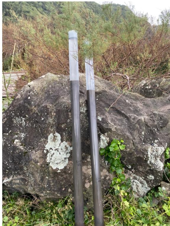
Figura 2.2 - *Core* de gravidade com as amostras obtidas, devidamente acondicionado na posição vertical.
