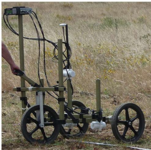
**Figura 3-** Equipamento de prospecção magnética utilizado
