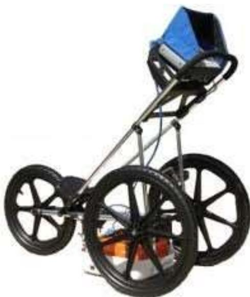
**Figura 2** Equipamento de GPR usado nos ensaios.
