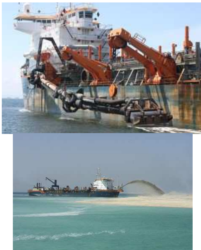
Figura 7 – Em cima, draga de sucção em marcha; em baixo, draga de sucção alimentando uma praia, retiradas de http://www.blogmercante.com/2010/09/fotos-draga-ham-310-da-van-oord/ .
