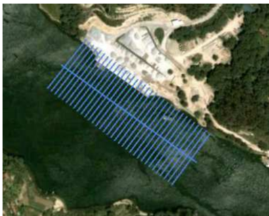
Figura 10 - Exemplo de planeamento de fiadas de um LH.
