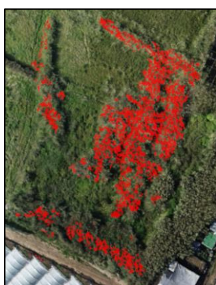
Figura 8.7 – Demonstração de confusões entre classes (1). Os pontos a vermelho representam aqueles que foram classificados como Ground e pertencem à classe High Vegetation .
