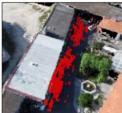
Figura 8.9 – Eliminação do ruído através da reclassificação. a) Ruído existente em locais com sombra; b) Ruído existente em telhados refletivos.
