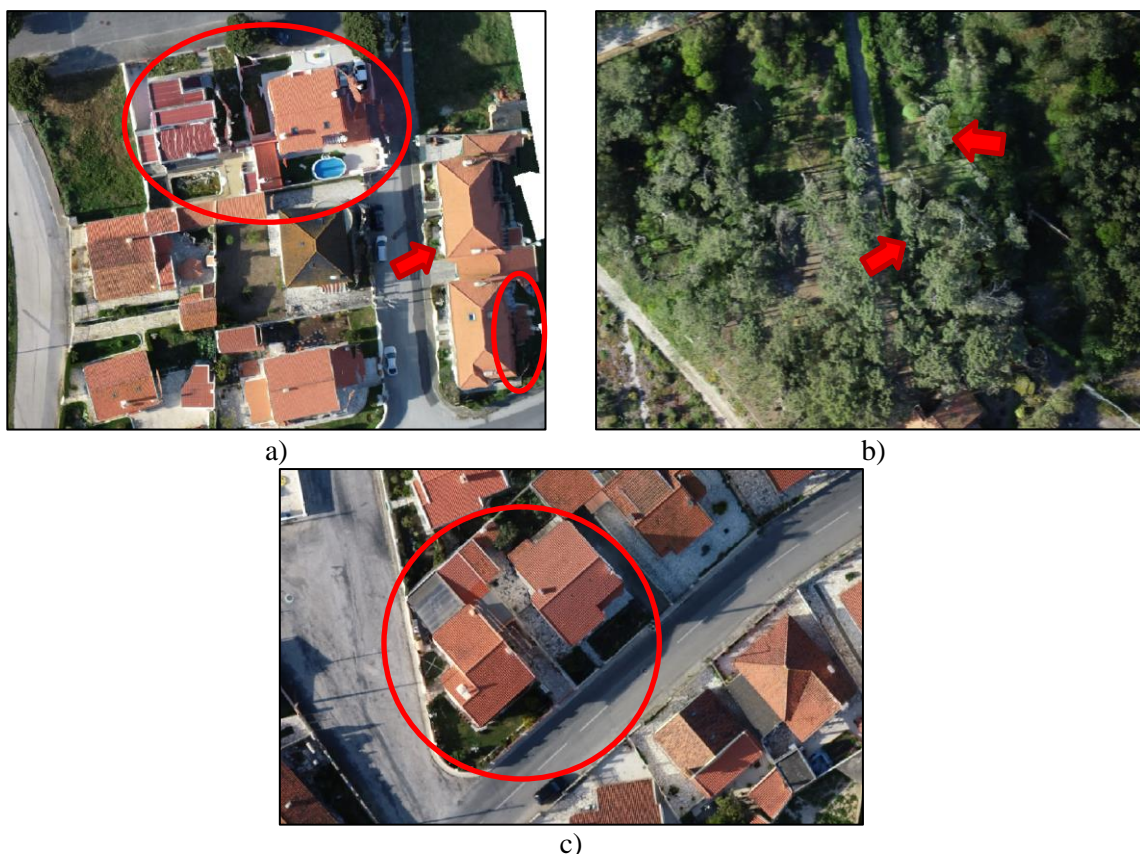
Figura 9.19 – Exemplos de deformações ocorridas no ortofotomapa. a) Deformações no limite do projeto; b) Deformações ocorridas em vegetação; c) Deformações junto ao limite do telhado
