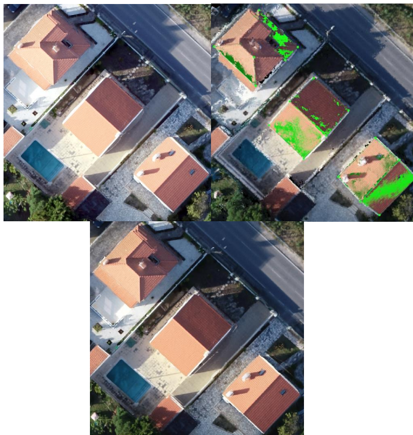
Figura 9.18 – Exemplo de edição da nuvem de pontos densificada e resultado na ortofoto (3).
