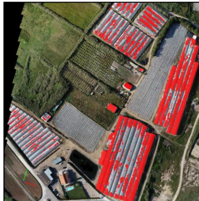
Figura 8.8 – Demonstração de confusões entre classes (2). Os pontos a vermelho representam aqueles que foram classificados como Building e/ou Road Surface e pertencem à classe Human Made Object .
