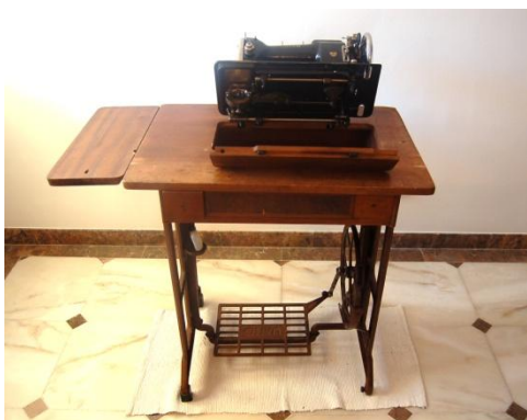
Fig. 129 - Processo de recolhimento. Etapa 3 - Levantar peça de madeira que apoia a máquina de costura.
