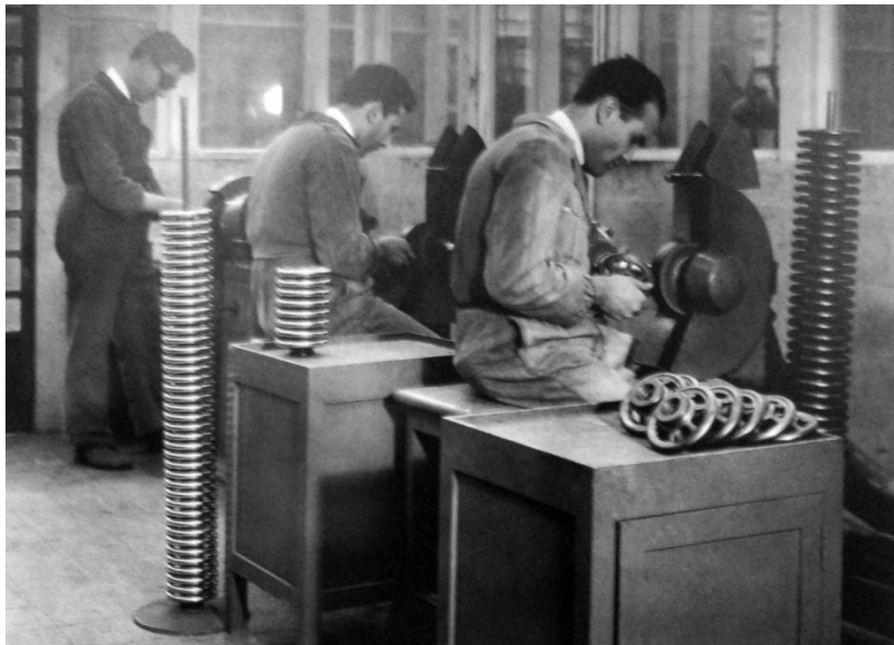
Fig. 81 - Polimento do volante.
