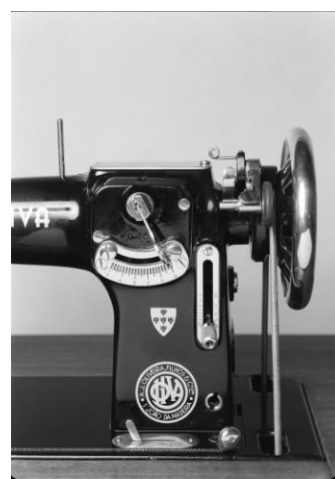
Fig. 21 - Pormenor de máquina cl. 46: Mecanismos do ponto ziguezague. Comparar com fig. 19 e 20.
