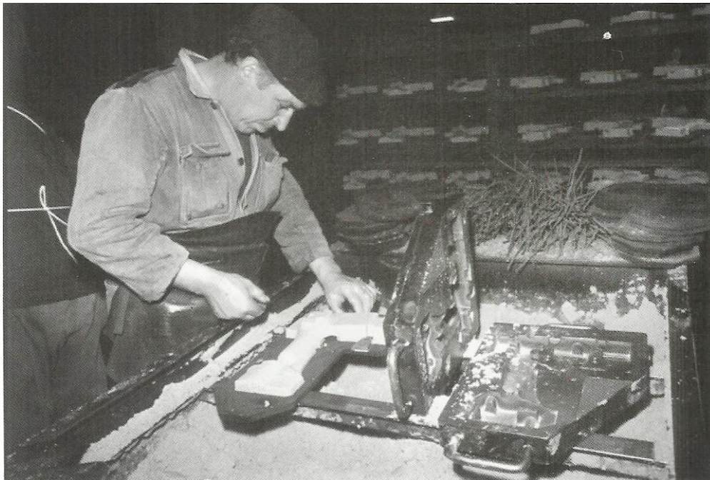
Fig. 56 - Desmoldação das peças (cabeça da máquina de costura).
