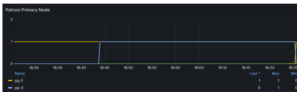
Figura 4.30: Observações de comutação no cluster (Patroni) C5.4
