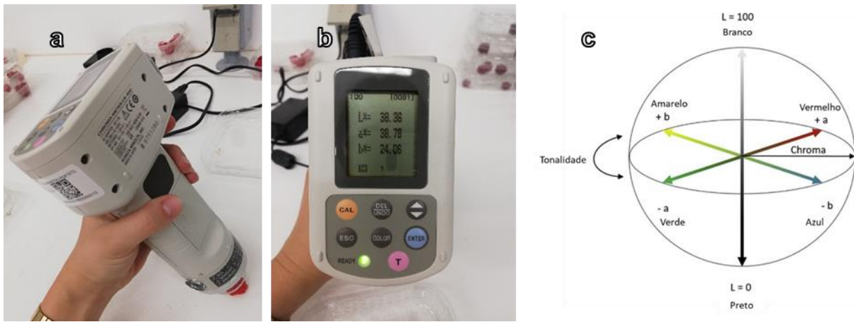
Figura 16 – Medição da cor de frutos de framboesa com colorímetro portátil Chroma-Meter CR-400 (Konica Minolta Sensing Americas Inc.) (a); mostrador com o valor das coordenadas medidas (b); espaço tridimensional formado pelos 3 eixos formulados pelo CIE (c) (Ly et al., 2020).
