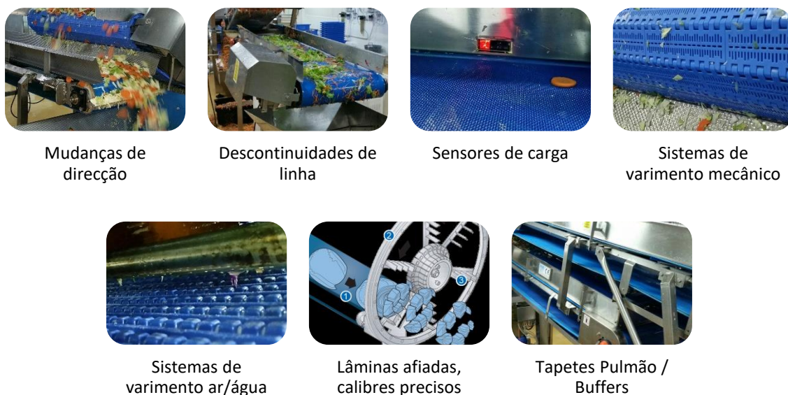
Figura 31 – Detalhes de ineficiências e equipamentos que promovem eficiência do processo
