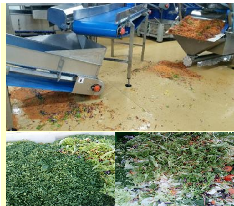
Figura 15 - Aspecto geral do tipo de resíduos gerados no processamento mínimo, resultantes de porções edíveis que se perdem devido ineficiências de equipamentos.
