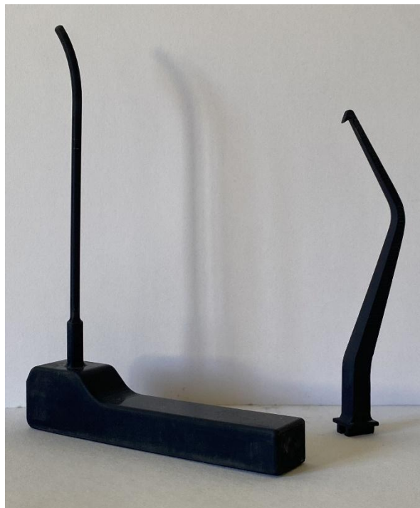
Figura 5.7 - Impressão 3D do apontador femoral e tibial, por meio da resina mencionada anteriormente e pela técnica de impressão LCD.
