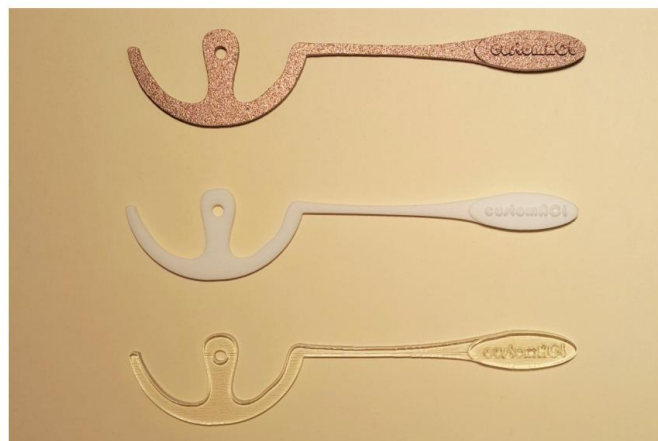
Figura 4.4 – Os três guias-específicos de cada paciente para a formação do túnel femoral na reconstrução do LCA, em três materiais diferentes: aço inoxidável 316L, plástico PA220 e fotopolímero à base de acrílico transparente. Adaptado de: [93]
