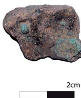
Figura 17 - Cadinho (CACII 3). Note-se a face interna muito escorificada, o nódulo esférico (canto superior esquerdo) e o nódulo disforme (canto inferior direito) analisados por micro espectrometria de fluorescência de raios X, dispersiva de energias.
