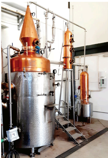
Figura 8 - Alambique de cobre com cabeça em cone e coluna com dois sistemas de retificação e um deflegmador em Cortelha (Loulé). Imagem de Vico Ughetto.
