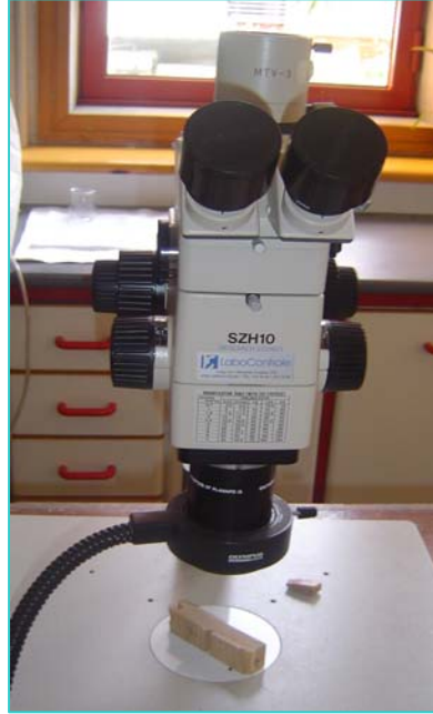
Fig. 3.12 – Microscópico Olympus SZH 10, com câmara de vídeo incorporada, usado na observação visual das rodelaas de pinho e eucalipto.
