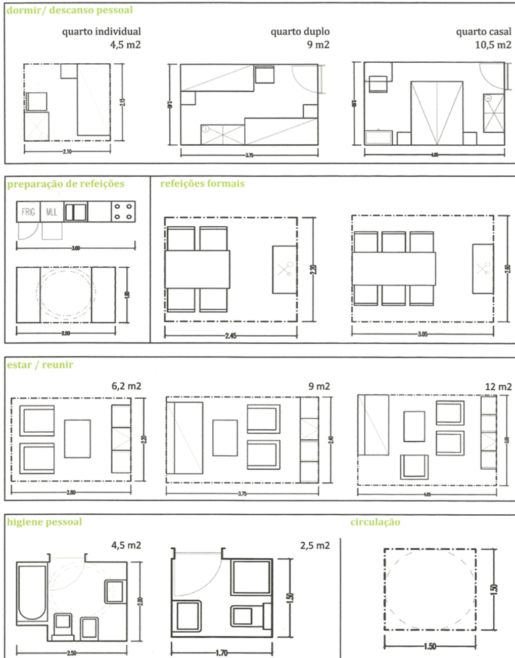
Quadro 2 | Quadro síntese com o respectivo mobiliário mínimo definido por João Branco Pedro, em Programa habitacional: espaços e compartimentos .
