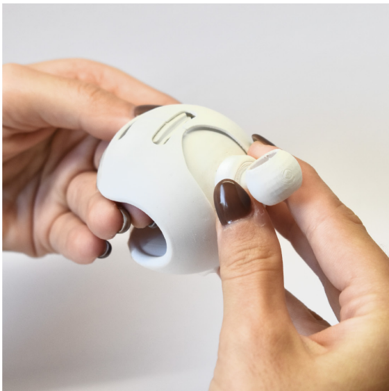
Processo de prototipagem, peças lixadas Fonte: Mariana Vieira, 2022.
