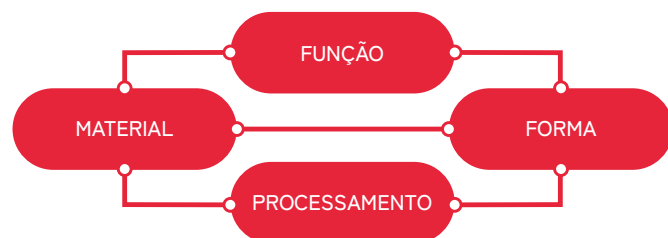
(Figura 10) Problema central da seleção de materiais. Interação entre Função, Forma, Processamento e Material, segundo Ashby e Johnson (2010)
