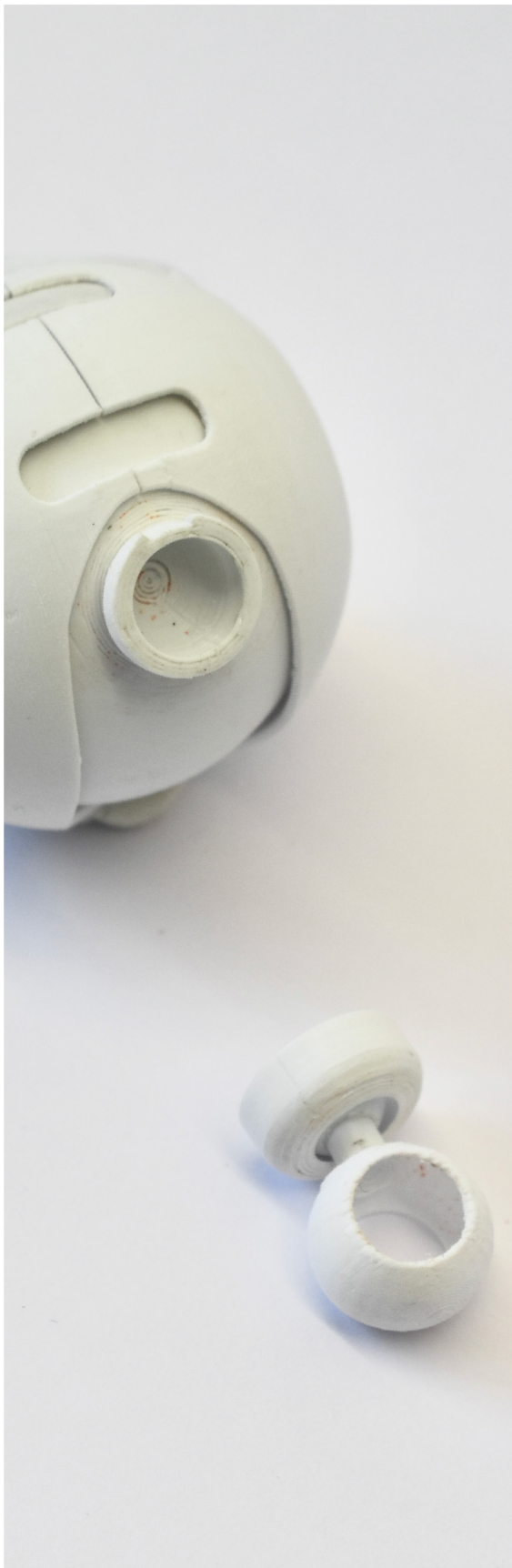
Processo de prototipagem, peças lixadas Fonte: Mariana Vieira, 2022.
