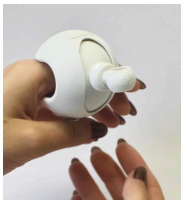
(Figura 48) Processo de prototipagem, peças lixadas Fonte: Mariana Vieira, 2022.
