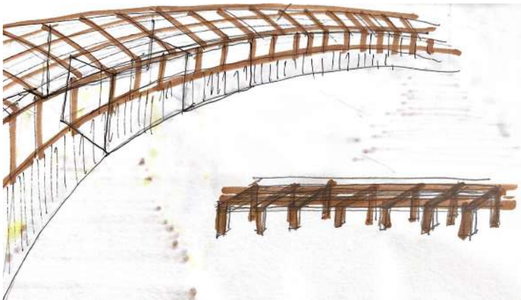
Fig 150. Esboço da ideia de uma estrutura à vista em madeira em sistema de pórtico.
