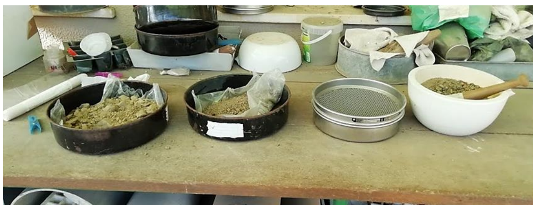
Figura 15 - Preparação das amostras de solo por peneiração e crivagem
