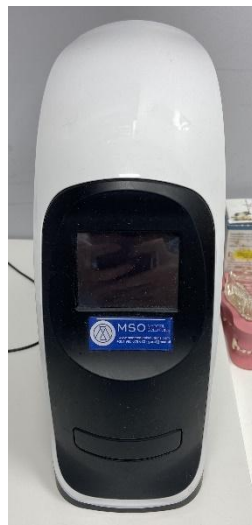
Figura 7 – Digitalizador de placas de fósforo (FireCR Dental - Bridge Power corp.) (fotografia original)
