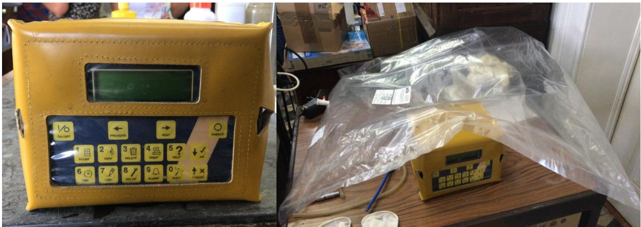
Figura 20 - Medidor de qualidade do biogás e o respetivo saco de armazenamento.
