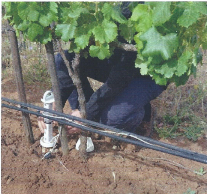
■ Photo 1 : Sonde capacitive, installée chez un producteur de vin de l'Alentejo (Reguengos de Monsaraz) utilisant des stratégies d'irrigation déficitaire (demofarm du projet NEFERTITI).
