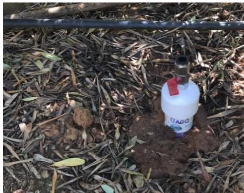
Figura 6. Cápsula porosa instalada e com a entrada de ar celada
