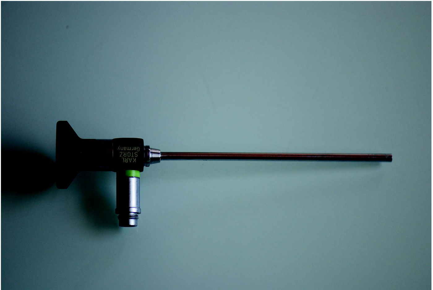
Fig 25 - Endoscópio rígido actual do fabricante alemão Karl Storz. É constituído por lentes cilíndricas de vidro ( Hopkins) ,uma lente ocular e fibras de vidro condutoras de luz fria.
