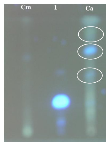
Figura 20 - Caracterização do extracto por TLC Sistema S3, observação a 366 nm Cm - extracto metanólico; 1 - harmano; Ca - extracto alcaloídico
