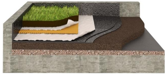
Imagem 63. Esquema estratificado de uma cobertura ajardinada, Imagem obtida em www.isocor.pt .
