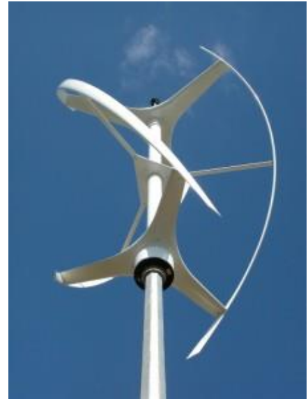
Imagem 73. Aerogerador de Eixo Vertical de rotor, Imagem obtida em www.aerogeradores.org .
