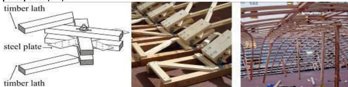
Figura 27 – Esquema da diagonal (esq.), conexão do tipo bota de jangada (centro) e torção da malha por suportes (dir.).
