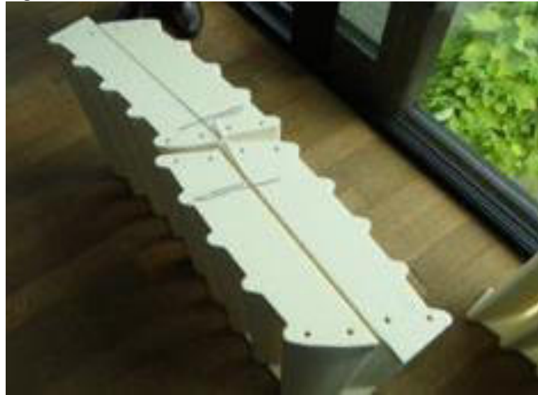
Figura 38 – Protótipo do bloco de concreto fabricado digitalmente com espuma de alta densidade.
