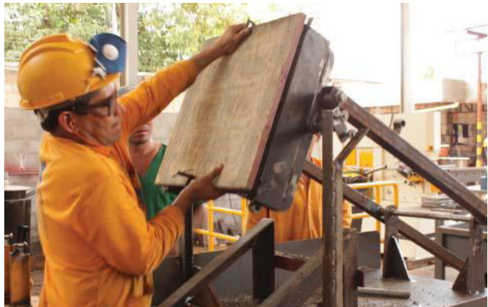
Figura 39 – Processo de desmoldagem do cobogó a partir de fôrma usinada.
