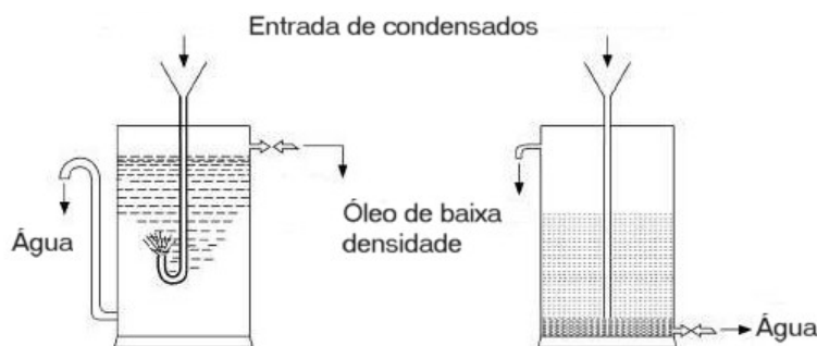
Fig. 9. “Florentinos” para separação do vapor condensado do óleo (Bandoni 2003).
