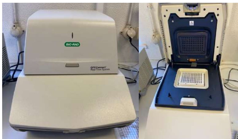
Figura 18 - Sistema CFX Connect Real-Time System (Bio-rad) utilizado para a realização do PCR em tempo real.
