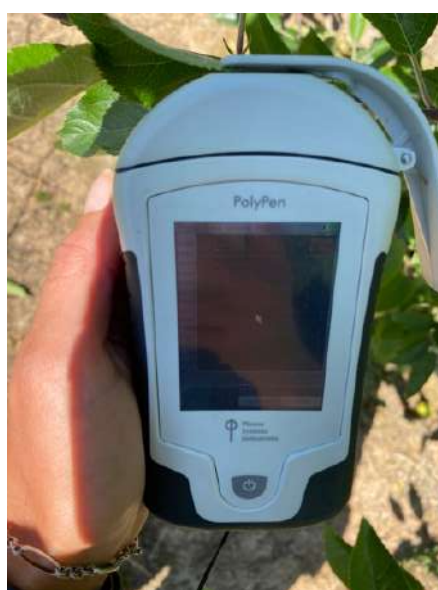
Figura 12 - Medição dos índices de reflectância com recurso a um analisador da reflectância das folhas portátil.
