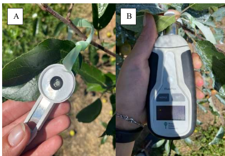
Figura 11 - Medição de parâmetros de fluorescência da clorofila com recurso a pinças (A) e um fluorómetro portátil (B).
