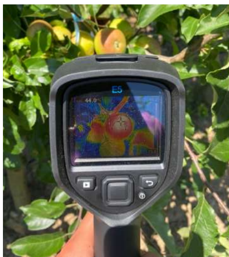
Figura 13 - Medição das temperaturas máximas das folhas e frutos das diferentes modalidades com recurso à câmara térmica FLIR E6-XT.
