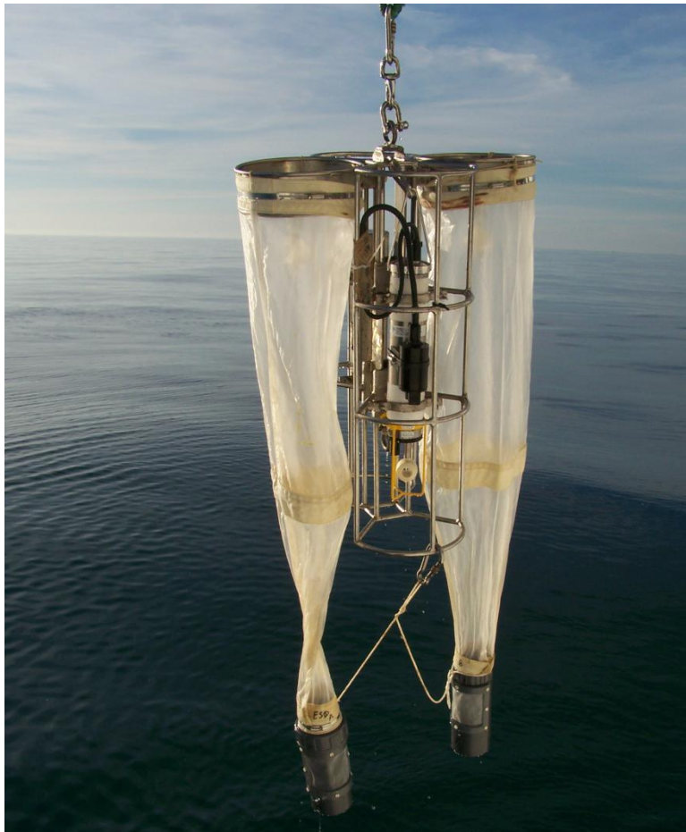
Figura 2. 4 – Rede CalVET, utilizada para recolha de plâncton, e registo de temperatura, salinidade e fluorescência (clorofila) nas campanhas dirigidas a MPDO. Fonte: IPMA, Documentos internos.
